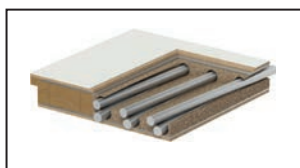
furatolt faforgácsbetét + acél rudak + alumínium betét
