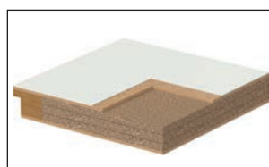
tűzálló, rétegelt faforgácsbetét (EI30)
