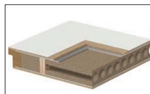
furatolt faforgácsbetét + ólomréteg (Röntgen)
