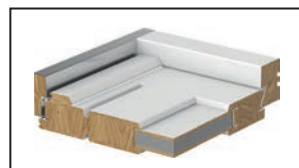
hőszigetelő betét B ( U = 1.7 \text{ W/m}^2 \text{ K} )
